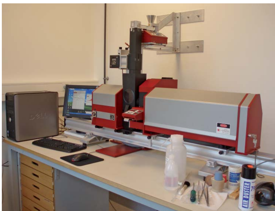
Laserdiffraktometer fra Sympatec placeret ved Geologisk Institut i Aarhus. (Foto: Charlotte Rasmussen)
