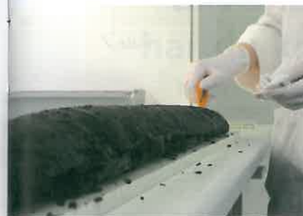
Før måling renses kernens overflade forsigtigt med en kniv.
